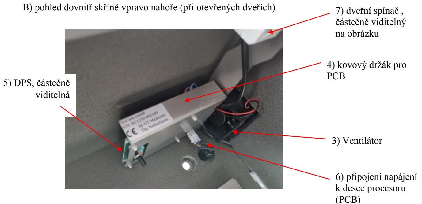
C) obrázek při sejmém krytu ventilátoru , který lze sejmout ručně (umístění viz obrázek A 1).
