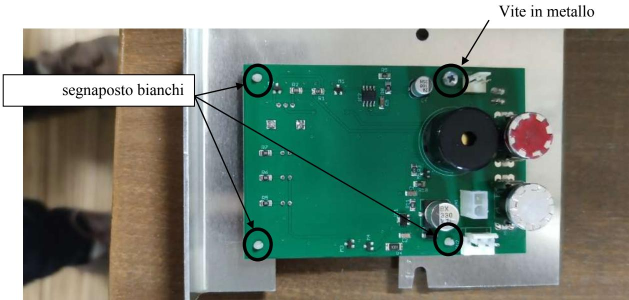
I segnaposto bianchi possono essere rimossi con una pinza o con le unghie. Se si stringe il lato inferiore, è possibile spingere i segnaposto bianchi attraverso il foro. Se necessario, svitare la vite.
