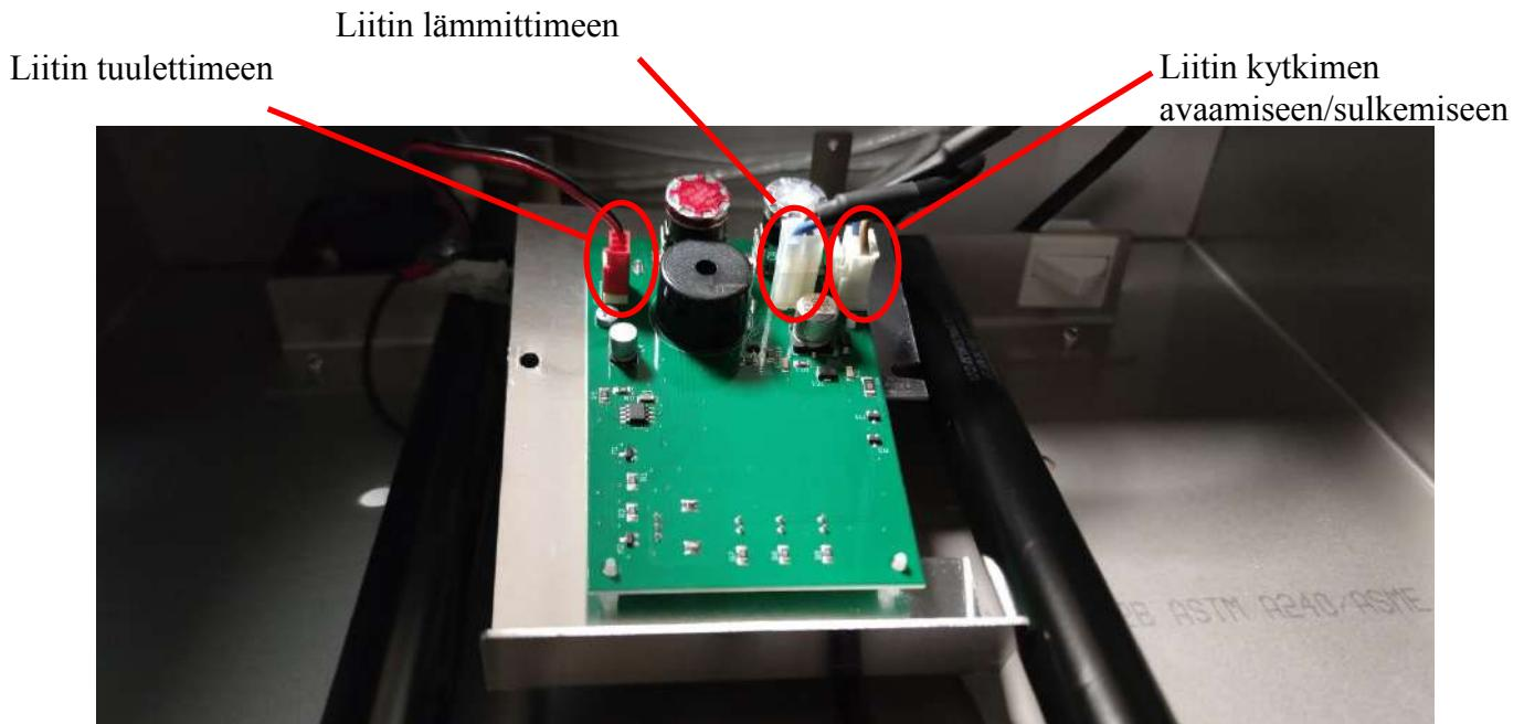
Kun levy, jonka päällä on piirilevy, on irronnut, sinun on irrotettava jäljellä olevat sähköliitännät:
