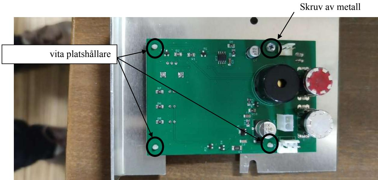
De vita plathållarna kan tas bort med hjälp av en tång eller naglarna. När du klämmer på undersidan kan du trycka de vita plathållarna genom hålet. Skruva loss skruven i förekommande fall.
