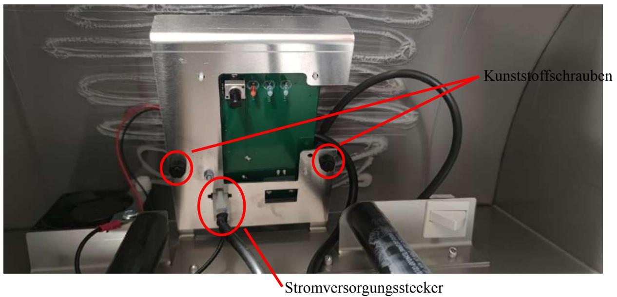
Um die Leiterplatte zu ersetzen, müssen Sie die 2 (Kunststoff-)Schrauben lösen, die die Platte mit der Leiterplatte oben halten. Ziehen Sie zunächst das Netzkabel an der Unterseite ab (siehe Abbildung oben). Ergebnis:
