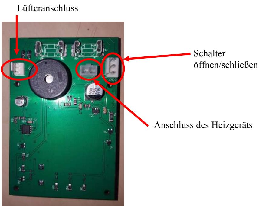
Bevor Sie die Leiterplatte mit den Platzhaltern an der Schublade befestigen, bringen Sie bitte die Anschlüsse wie in der Abbildung oben beschrieben an. Wenn diese drei Verbindungen hergestellt sind, setzen Sie die Platine mit den weißen Platzhaltern auf die Schublade. Der Stromanschluss, die LEDS und der Drehknopf sollten durch die Schubladenplatte passen (manchmal muss man ein wenig "quetschen").
