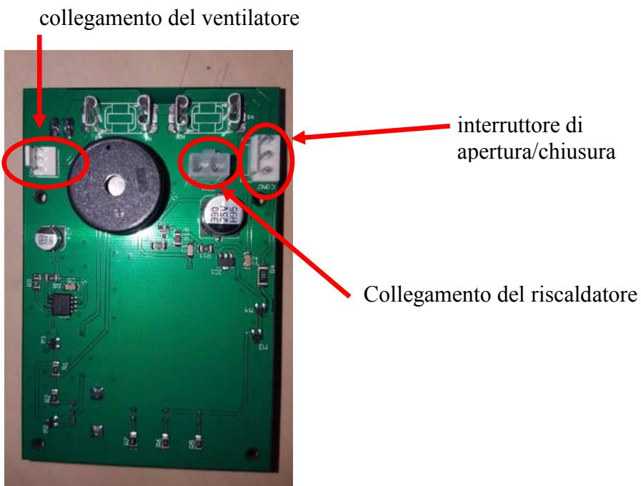
Prima di fissare il PCB sul cassetto utilizzando i segnaposto, collegare i collegamenti come descritto nella figura precedente. Una volta completati questi tre collegamenti, posizionare il PCB sul cassetto utilizzando i segnaposto bianchi. Il collegamento di alimentazione, i LED e la manopola devono passare attraverso la piastra del cassetto (a volte è necessario "stringere" un po').
