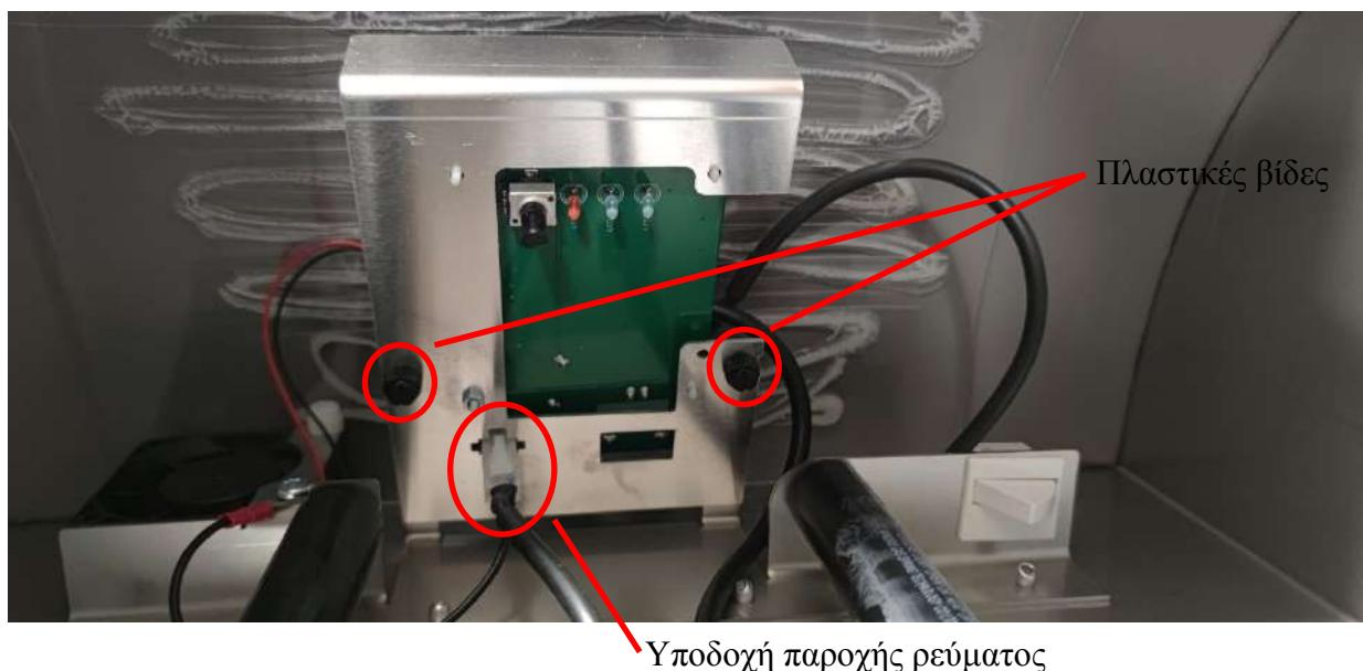
Για να αντικαταστήσετε την πλακέτα τυπωμένου κυκλώματος (PCB), πρέπει να χαλαρώσετε τις 2 (πλαστικές) βίδες που συγκρατούν την πλάκα με την πλακέτα τυπωμένου κυκλώματος από πάνω. Πρώτα αποσυνδέστε το καλώδιο τροφοδοσίας στην κάτω πλευρά (βλ. παραπάνω εικόνα). Αποτέλεσμα: Η πλακέτα θα πρέπει να τοποθετηθεί σε ένα από τα εξαρτήματα της πλακέτας:
