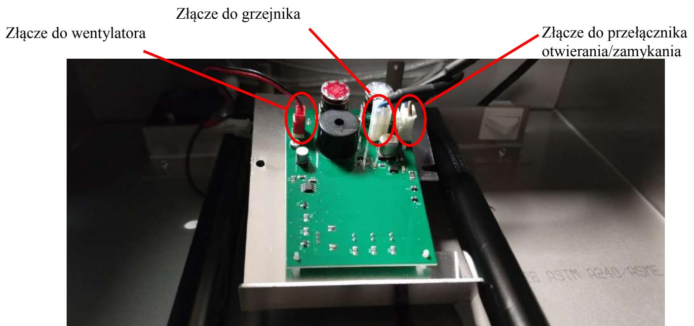
Gdy płyta z PCB na górze jest luźna, należy odłączyć pozostałe połączenia elektryczne:
