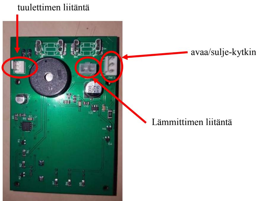
Ennen kuin kiinnität piirilevyn laatikkoon paikallaan pidikkeillä, kiinnitä liitännät yllä olevan kuvan mukaisesti. Kun nämä kolme liitintää on tehty, aseta piirilevy laatikkoon valkoisten pidikkeiden avulla. Virtaliitännän, LEDien ja käänönupin pitäisi mahtua laatikon levyn läpi (joskus sinun täytyy "puristaa" hieman).
