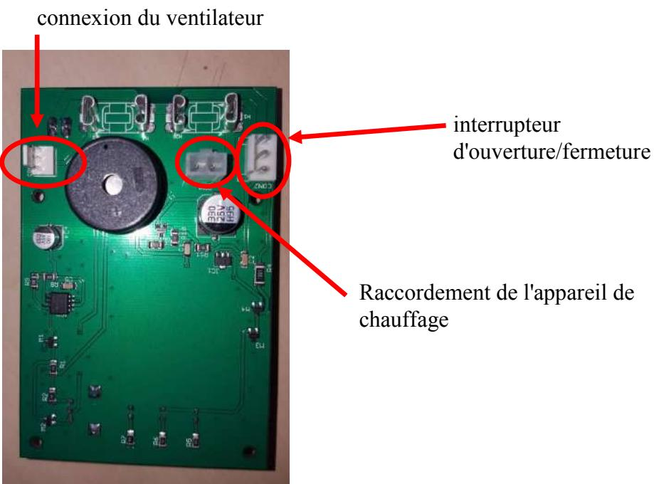
Avant de fixer le circuit imprimé sur le tiroir à l'aide des supports, il convient d'effectuer les raccordements décrits dans l'image ci-dessus. Une fois ces trois connexions effectuées, placez le circuit imprimé sur le tiroir à l'aide des supports blancs. La connexion d'alimentation, les LEDS et le bouton tournant doivent passer à travers la plaque du tiroir (il faut parfois "serrer" un peu).
