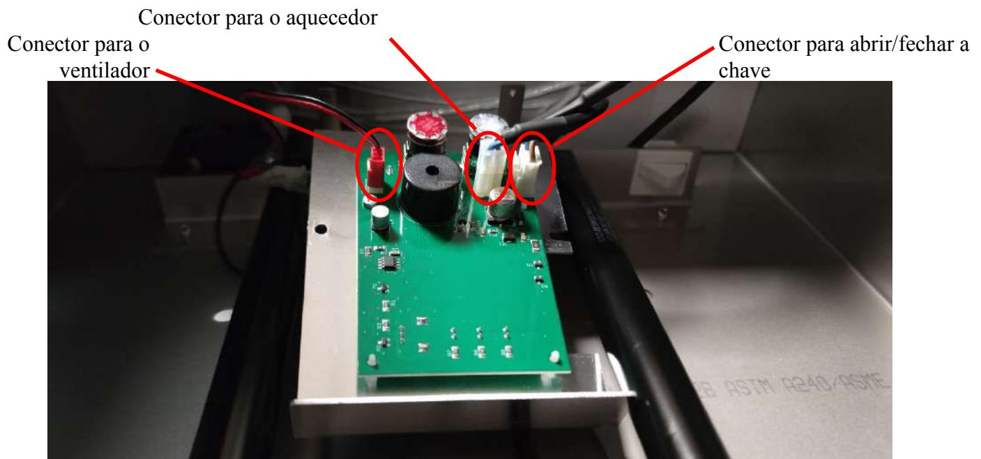
Quando a placa com a PCB na parte superior estiver solta, você precisará desacoplar as conexões elétricas restantes:
