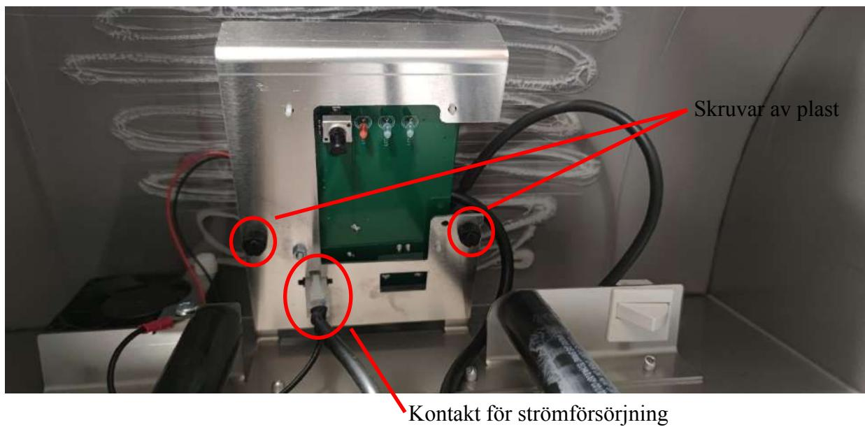
För att byta ut PCB (Printed Circuit Board) måste du lossa de 2 (plast)skruvarna som håller fast plattan med PCB på ovansidan. Koppla först ur strömkabeln på undersidan (se bilden ovan). Resultat:
