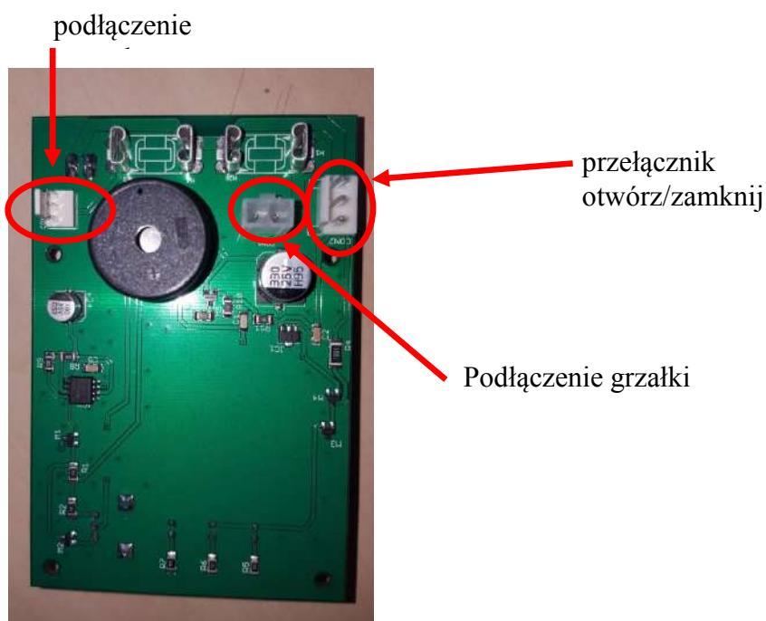
Przed przymocowaniem płytki drukowanej do szuflady za pomocą uchwytów, należy przymocować połączenia w sposób opisany na powyższym rysunku. Po wykonaniu tych trzech połączeń umieść płytę PCB na szufladzie za pomocą białych uchwytów. Połączenie zasilania, diody LED i pokrętło powinny pasować do płyty szuflady (czasami trzeba trochę "ścisnąć").
