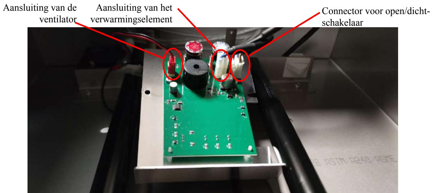
Als de plaat met de printplaat erop los is, moet je de elektrische restverbindingen loskoppelen:
