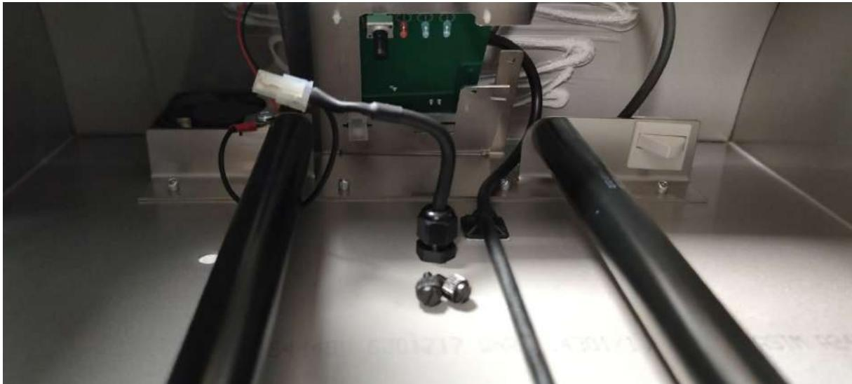
Nyt voit tuoda aluminiilevyn ja piirilevyn alas:
