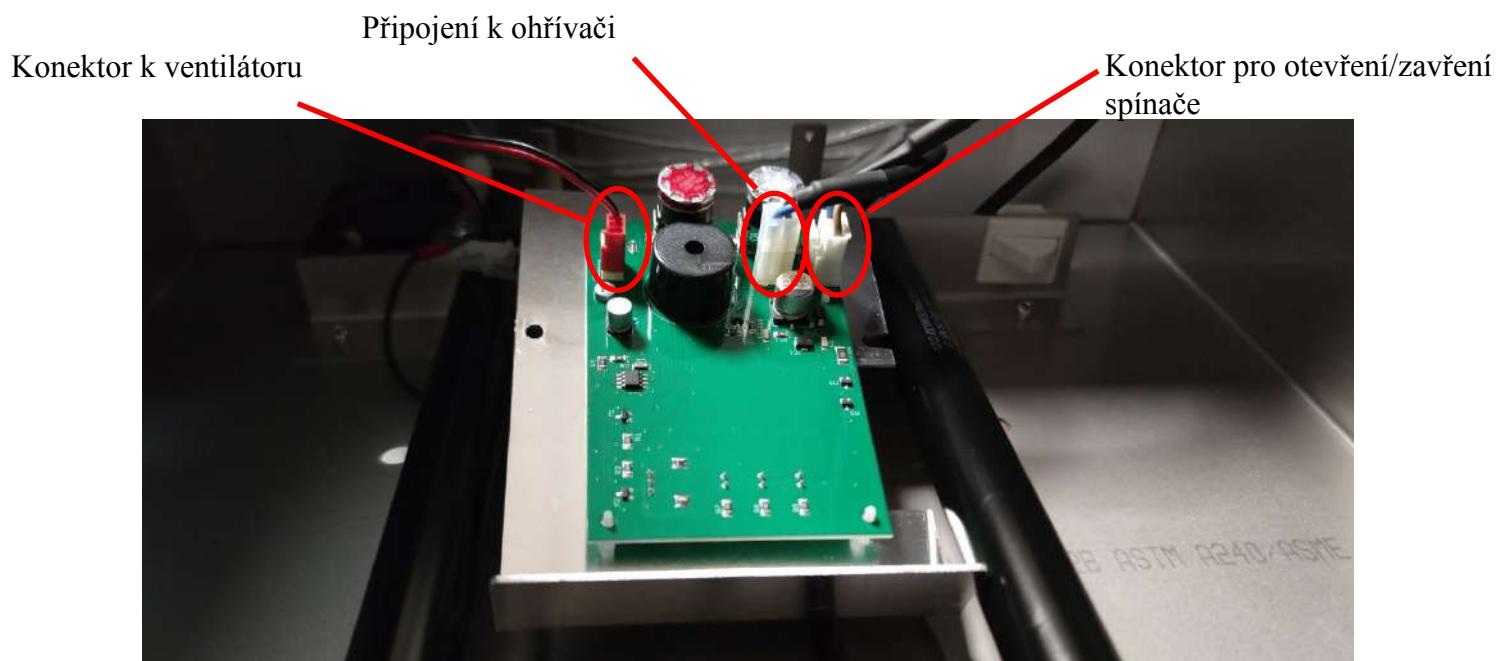
Když je deska s deskou plošných spojů nahoře uvolněná, je třeba odpojit zbývající elektrické spoje:
