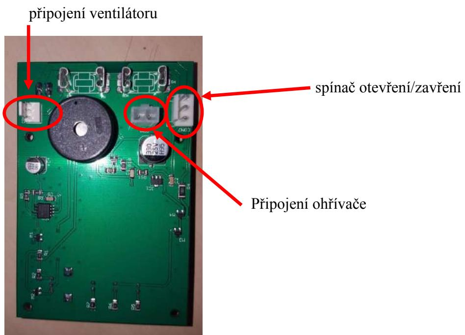
Před připevněním desky plošných spojů na zásuvku pomocí držáků připevněte spoje, jak je popsáno na obrázku výše. Po dokončení těchto tří spojů umístěte desku plošných spojů na zásuvku pomocí bílých držáků. Napájecí přípojka, LED diody a otočný knoflík by se měly vejít do desky zásuvky (někdy je třeba je trochu "zmáčknout").
