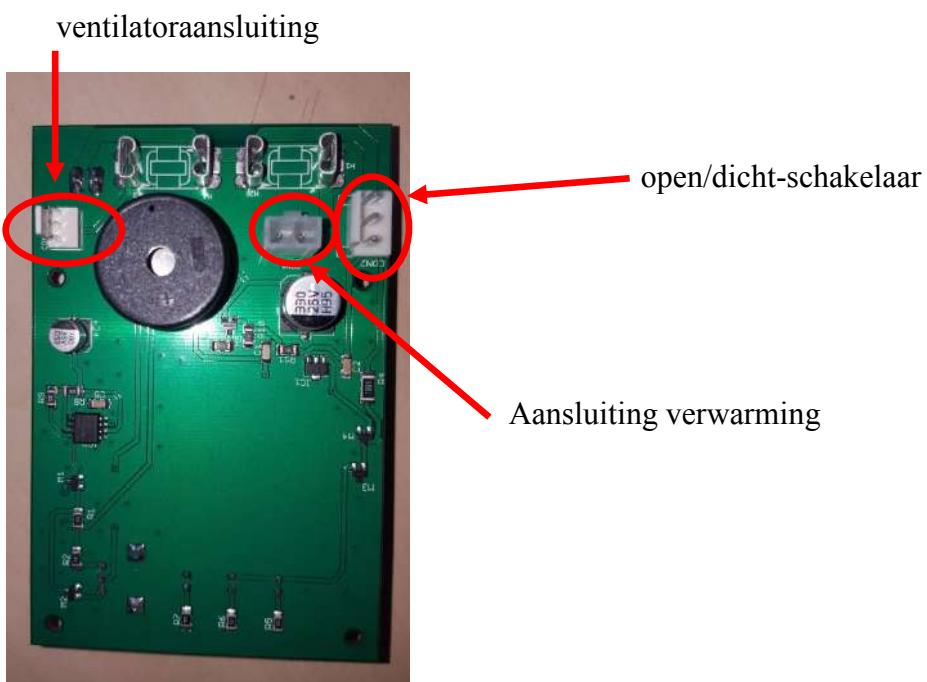
Voordat u de printplaat op de plaat plaatst met behulp van de plaatshouders, moet u de aansluitingen maken zoals beschreven in de bovenstaande afbeelding. Als deze drie aansluitingen klaar zijn, plaats je de printplaat op de plaat met behulp van de witte plaatshouders. De voedingsaansluiting, de LEDS en de draaiknop moeten door de gaten in de plaat passen (soms moet je een beetje "knijpen").
