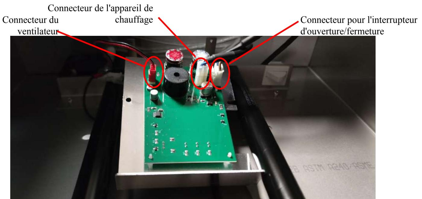
Lorsque la plaque sur laquelle se trouve la carte de circuits imprimés est desserrée, vous devez découpler les autres connexions électriques :
