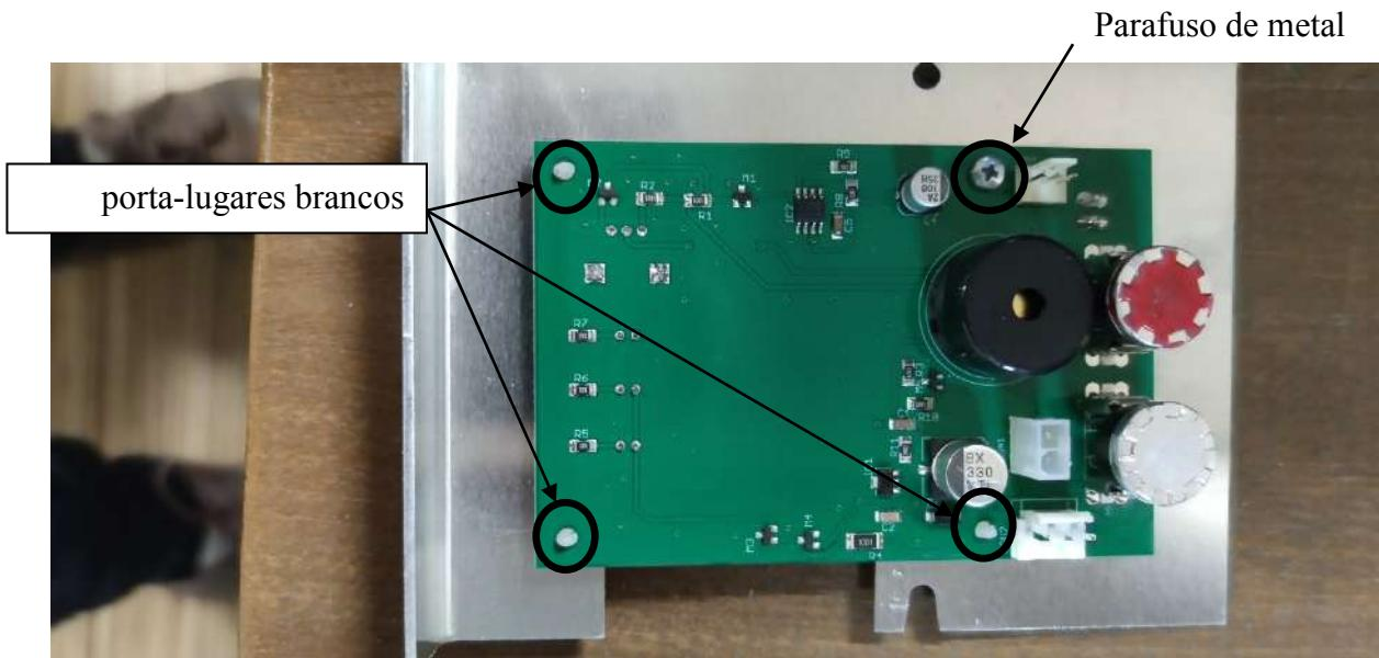
Os marcadores de lugar brancos podem ser removidos com uma pinça ou com as unhas. Quando você belisca o lado inferior, pode empurrar os marcadores de lugar brancos pelo orifício. Desparafuse o parafuso quando aplicável.
