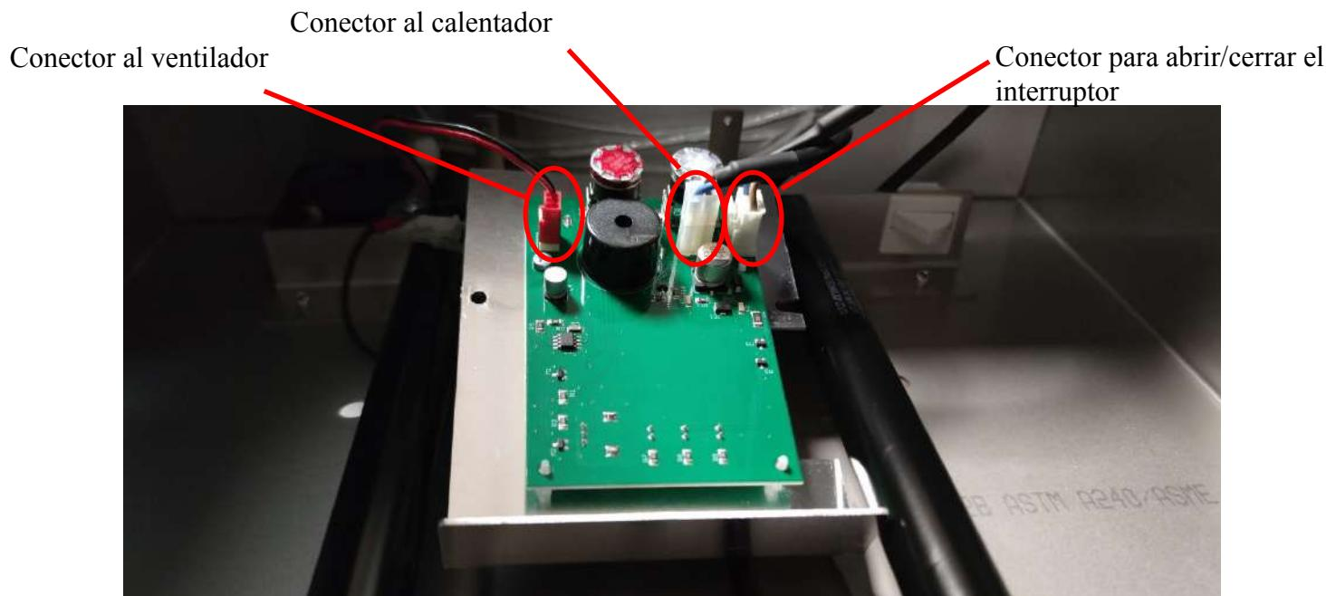
Cuando la placa con el PCB en la parte superior está suelto, es necesario desacoplar las conexiones eléctricas restantes:
