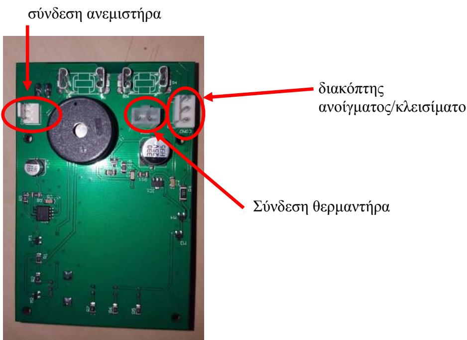
Πριν τοποθετήσετε την πλακέτα στο συρτάρι χρησιμοποιώντας τους υποδοχείς θέσεων, συνδέστε τις συνδέσεις όπως περιγράφεται στην παραπάνω εικόνα. Όταν ολοκληρωθούν αυτές οι τρεις συνδέσεις, τοποθετήστε την πλακέτα PCB στο συρτάρι χρησιμοποιώντας τους λευκούς υποδοχείς θέσεων. Η σύνδεση ρεύματος, οι LEDS και το κουμπί περιστροφής θα πρέπει να χωράνε μέσα από την πλάκα του συρταριού (μερικές φορές πρέπει να "στριμώξετε" λίγο).
