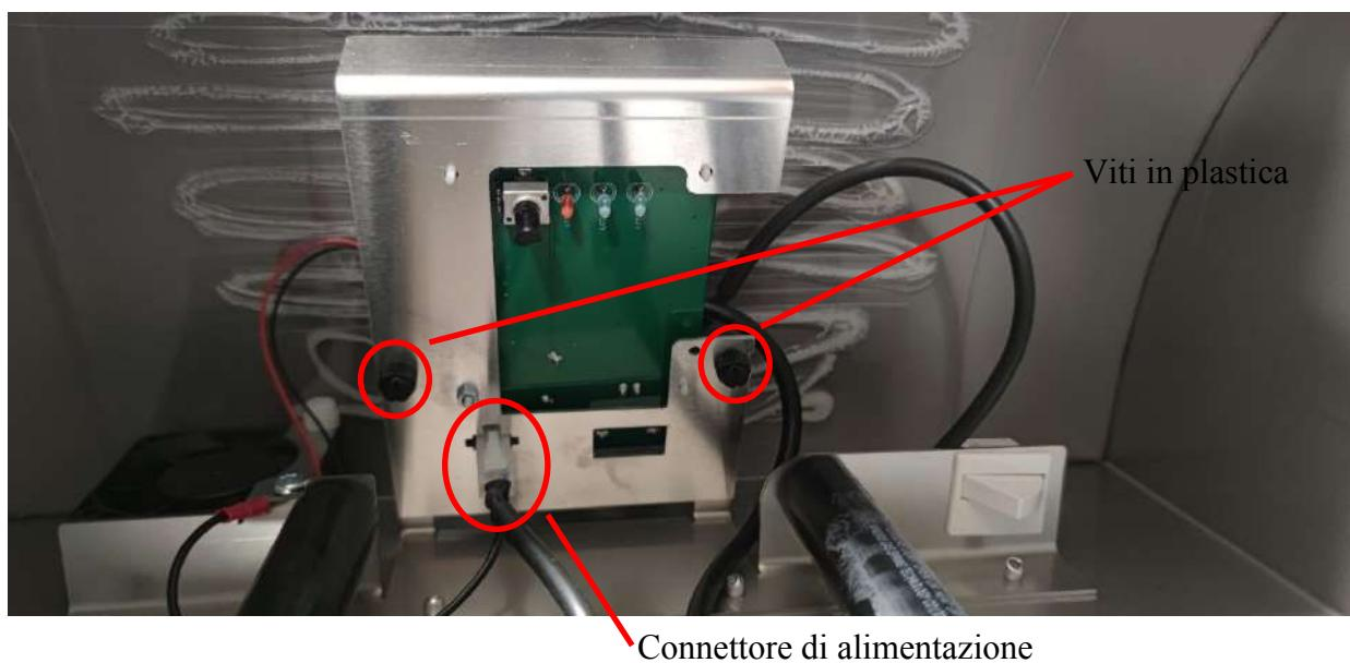
Per sostituire il PCB (Printed Circuit Board), è necessario allentare le 2 viti (in plastica) che tengono la piastra con il PCB in cima. Per prima cosa scollegare il cavo di alimentazione sul lato inferiore (vedere l'immagine sopra). Risultato:
