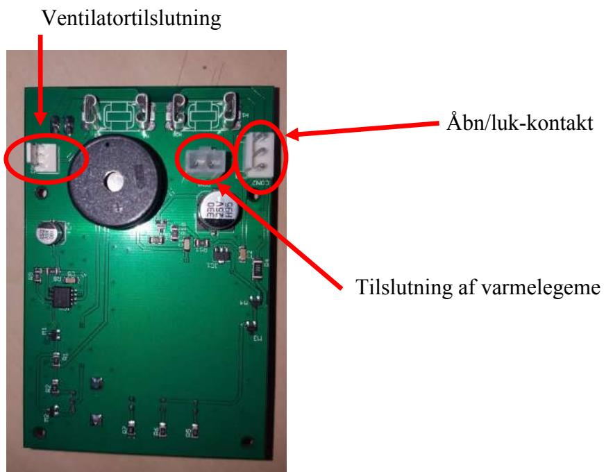
Før du monterer printkortet på skuffen ved hjælp af pladholderne, skal du montere forbindelserne som beskrevet på billedet ovenfor. Når disse tre forbindelser er færdige, skal du placere printkortet på skuffen ved hjælp af de hvide pladsholdere. Strømtislutningen, LED'erne og drejeknappen skal passe gennem skuffepladen (nogle gange skal du "klemme" lidt).
