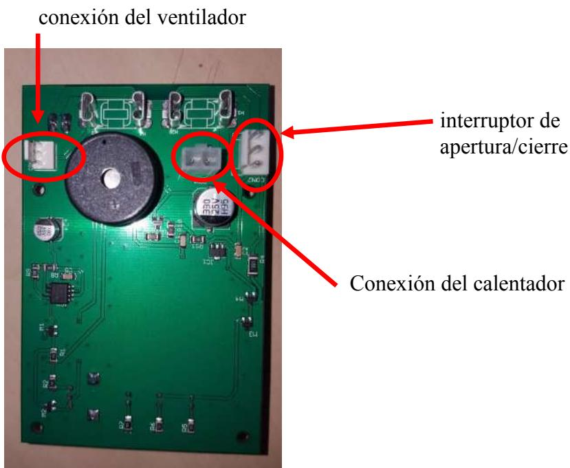
Antes de colocar la placa de circuito impreso en el cajón utilizando los soportes, realice las conexiones tal y como se describe en la imagen anterior. Una vez realizadas estas tres conexiones, coloque la placa de circuito impreso en el cajón utilizando los soportes blancos. La conexión de alimentación, los LEDS y el botón giratorio deben caber a través de la placa del cajón (algunas veces hay que "apretar" un poco).
