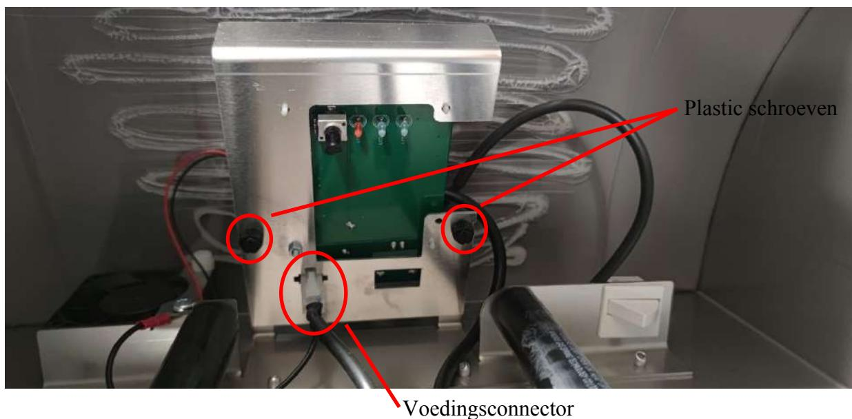
Om de printplaat (Printed Circuit Board) te vervangen, moet je de 2 (plastic) schroeven losdraaien die de plaat met de printplaat bovenop vasthouden. Maak eerst de voedingskabel aan de onderkant los (zie foto hierboven). Resultaat:
