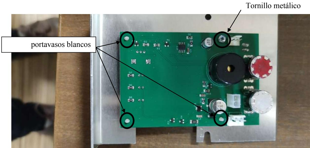
Los portavasos blancos pueden retirarse con una pinza o con las uñas. Al pellizcar en la parte inferior, puede empujar los portavasos blancos a través del orificio. Desenrosque el tornillo cuando proceda.
