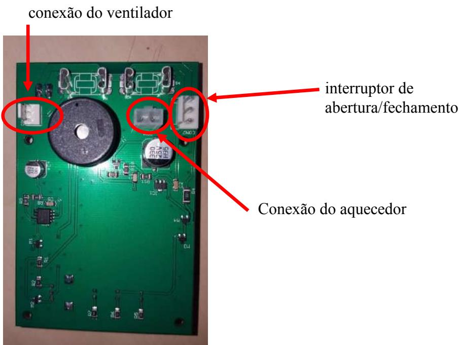
Antes de fixar a placa de circuito impresso na gaveta usando os suportes de lugar, faça as conexões conforme descrito na figura acima. Quando essas três conexões estiverem concluídas, coloque a placa de circuito impresso na gaveta usando os suportes brancos. A conexão de energia, os LEDs e o botão giratório devem passar pela placa da gaveta (às vezes é preciso "apertar" um pouco).
