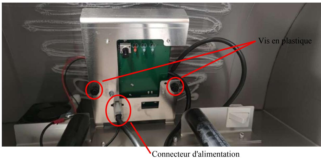
Pour remplacer le PCB (Printed Circuit Board), vous devez desserrer les 2 vis (en plastique) qui maintiennent la plaque avec le PCB sur le dessus. Débranchez d'abord le câble d'alimentation sur le côté inférieur (voir l'image ci-dessus). Résultat :
