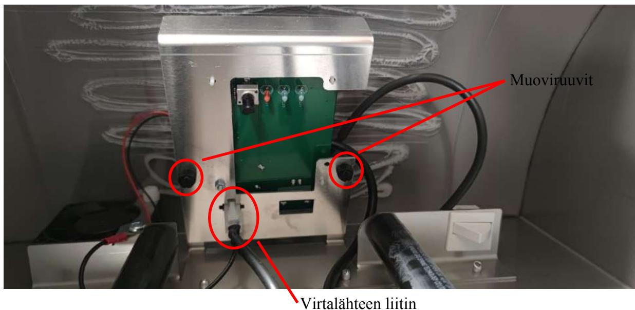
Vaihtaaksesi piirilevyn (Printed Circuit Board) sinun on löysättävä 2 (muovista) ruuvia, jotka pitävät levyä, jossa piirilevy on päällä. Irrota ensin virtajohto alapuolelta (katso kuva yllä). Tulos:
