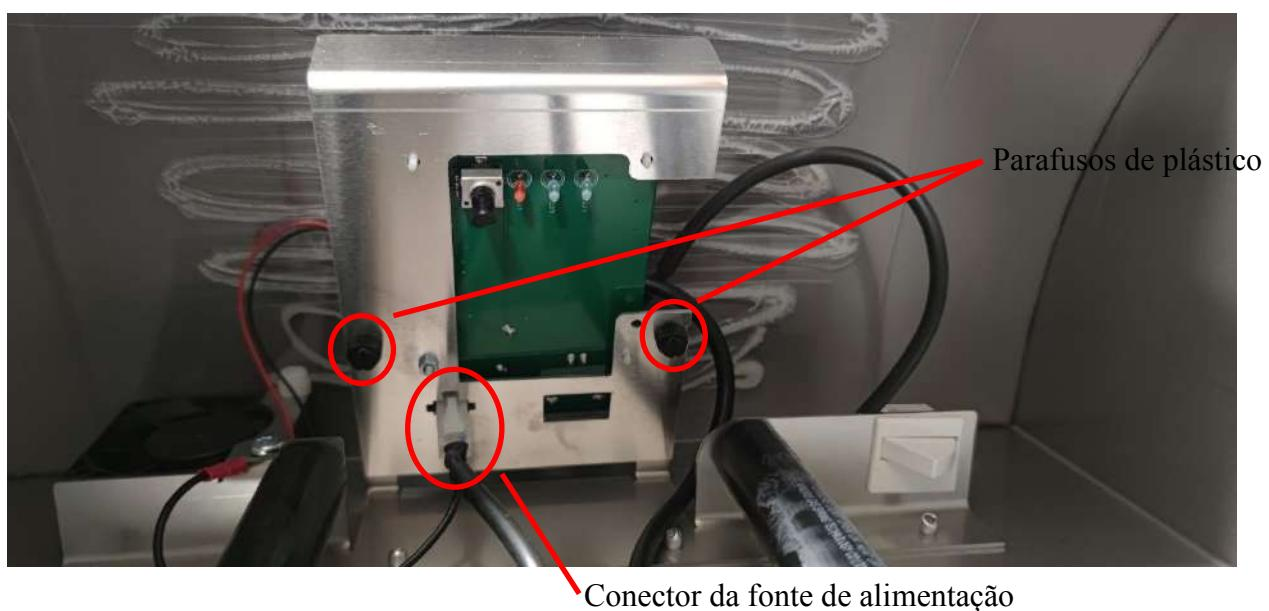
Para substituir a PCB (placa de circuito impresso), é necessário soltar os dois parafusos (de plástico) que prendem a placa com a PCB na parte superior. Primeiro, desconecte o cabo de alimentação na parte inferior (veja a figura acima). Resultado:
