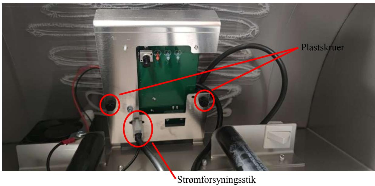
For at udskifte PCB (Printed Circuit Board) skal du løsne de 2 (plastik)skruer, der holder pladen med PCB på toppen. Træk først strømkablet ud på undersiden (se billede ovenfor). Resultat:
