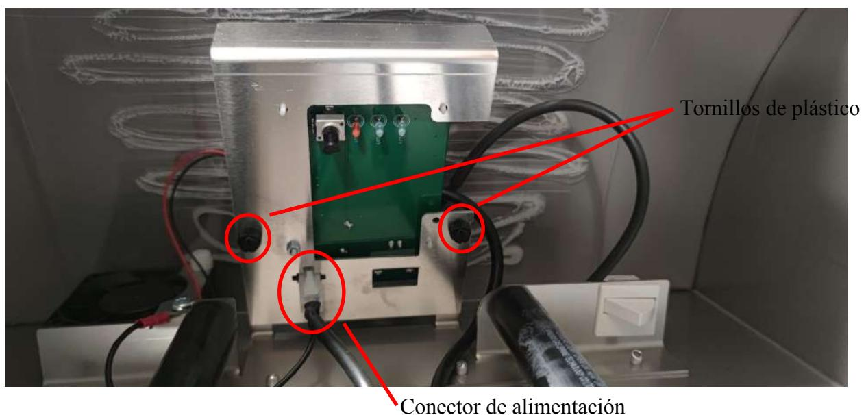
Para sustituir la PCB (Printed Circuit Board), es necesario aflojar los 2 tornillos (de plástico) que sujetan la placa con la PCB en la parte superior. Primero desenchufa el cable de alimentación de la parte inferior (ver imagen superior). Resultado:
