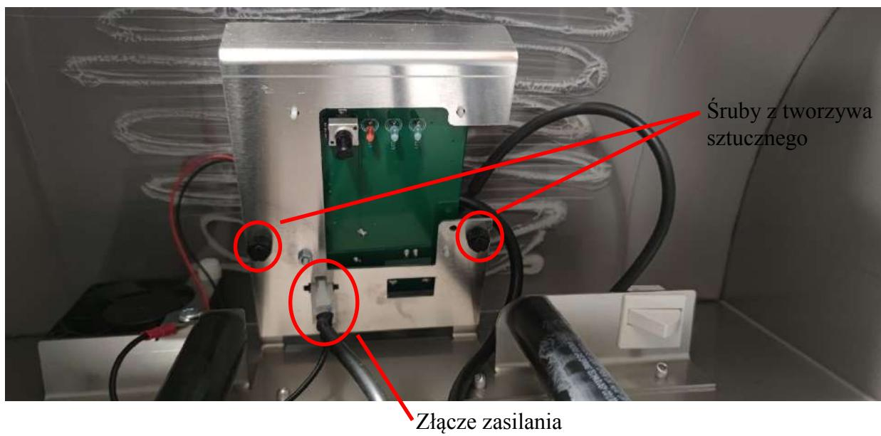
Aby wymienić płytę PCB (Printed Circuit Board), należy poluzować 2 (plastikowe) śruby, które przytrzymują płytę z płytą PCB na górze. Najpierw odłącz kabel zasilający w dolnej części (patrz zdjęcie powyżej). Wynik:
