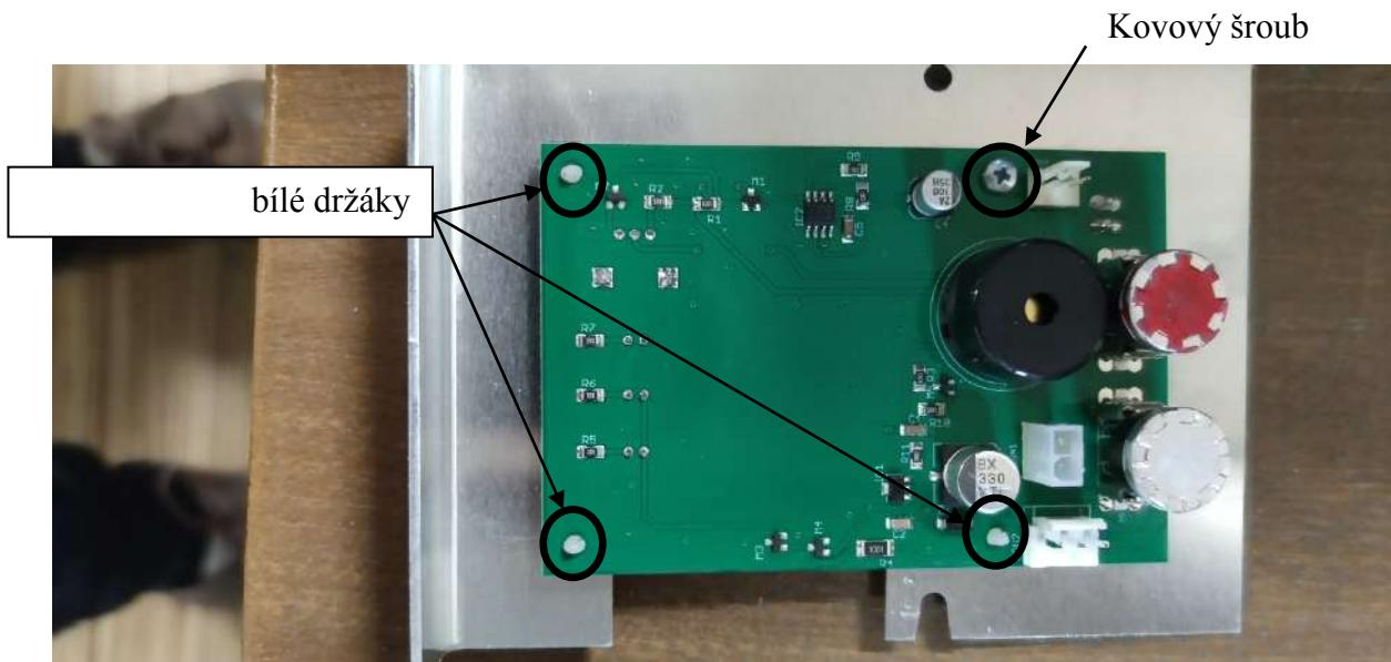
Bílé držáky lze odstranit pomocí kleští nebo nehtů. Když sevřete spodní stranu, můžete bílé držáky prostrčit otvorem. V případě potřeby vyšroubujte šroub.
