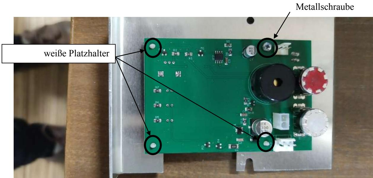
Die weißen Platzhalter können mit einer Zange oder mit den Nägeln entfernt werden. Wenn Sie an der Unterseite drücken, können Sie die weißen Platzhalter durch das Loch schieben. Schrauben Sie gegebenenfalls die Schraube heraus.
