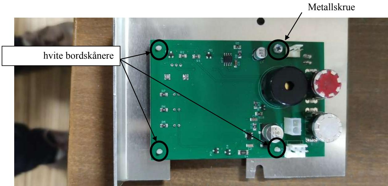
De hvite bordholderne kan fjernes ved hjelp av en knipetang eller neglene dine. Når du klemmer på undersiden, kan du skyve de hvite plassholderne gjennom hullet. Skru ut skruen når det er aktuelt.
