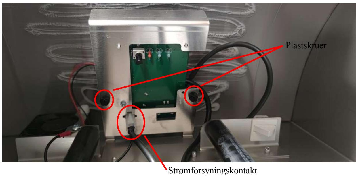
For å skifte ut kretskortet må du løsne de to (plast)skruene som holder platen med kretskortet på toppen. Trekk først ut strømkabelen på undersiden (se bildet ovenfor). Resultat:
