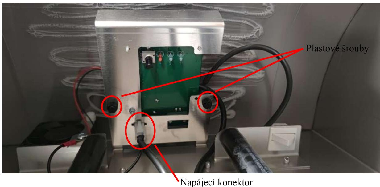
Chcete-li vyměnit desku plošných spojů (PCB), musíte povolit 2 (plastové) šrouby, které drží desku s PCB nahoře. Nejprve odpojte napájecí kabel na spodní straně (viz obrázek výše). Výsledek:
