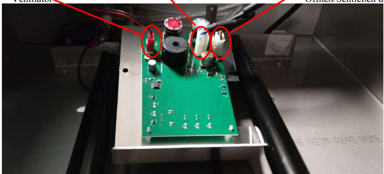
Wenn die Platte mit der Leiterplatte oben lose ist, müssen Sie die verbleibenden elektrischen Verbindungen entkoppeln:
